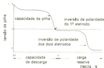
figura 9 — Curva de tensão da pilha durante uma reversão. Cargas inversas em excesso (quando, por exemplo, muitas pilhas estão ligadas em série) podem resultar em danos permanentes para a pilha.
